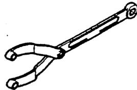
**OIL PUMP OIL SEAL INSTALLER**
