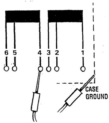
TEST EACH WINDING TO CASE GROUND
